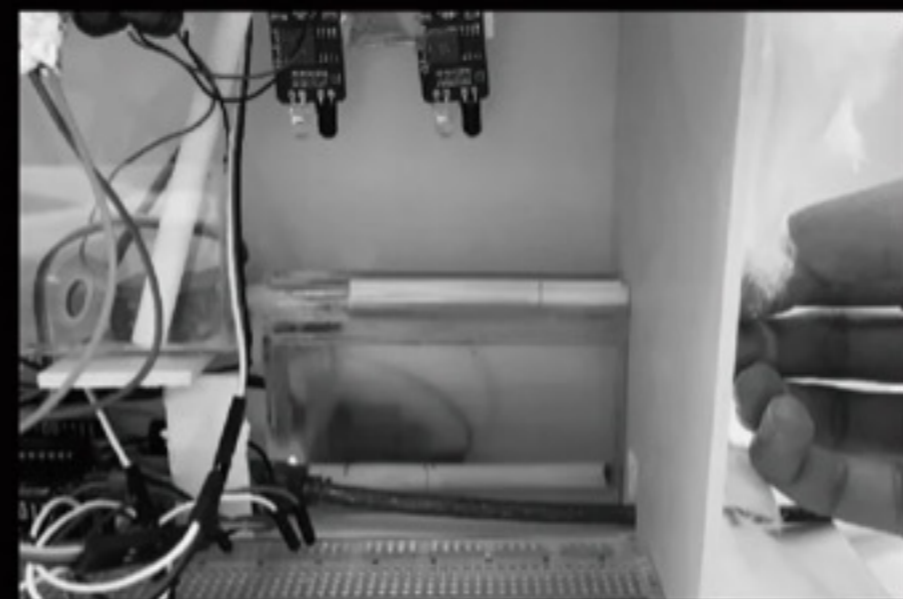
STEP 2 | タバコは赤外線センサー①を通過する。
