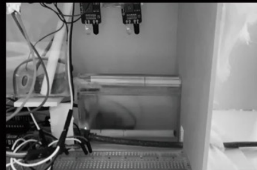
STEP 4 | 赤外線センサー①と②は物を検知する。
