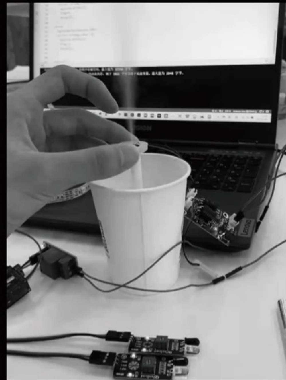
噴霧モジュールが作動したとき。
