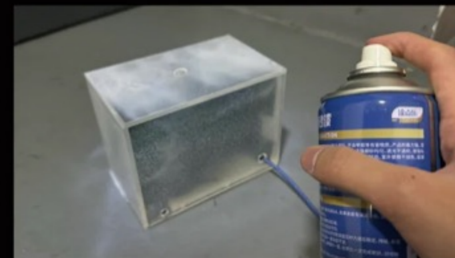
モジュール配線が見えないようフロスト塗装を施す。
